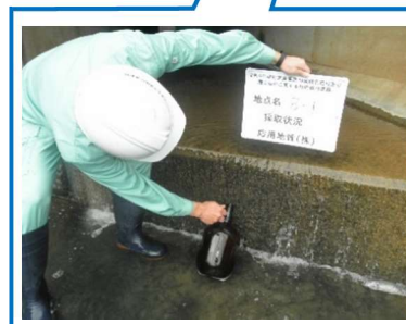
写真 4.6 放出水の調査状況
