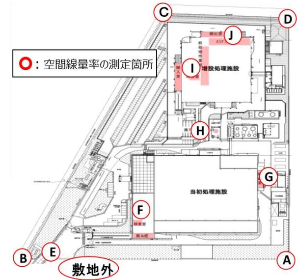
JESCO北海道事業所の空間線量率測定結果（処理後モニタリング）
