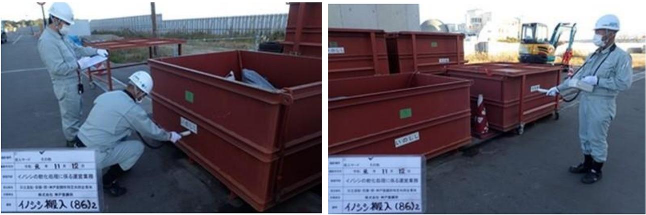
図 4- 24 受入ボックスの表面線量率及び周辺空間線量率測定場所
