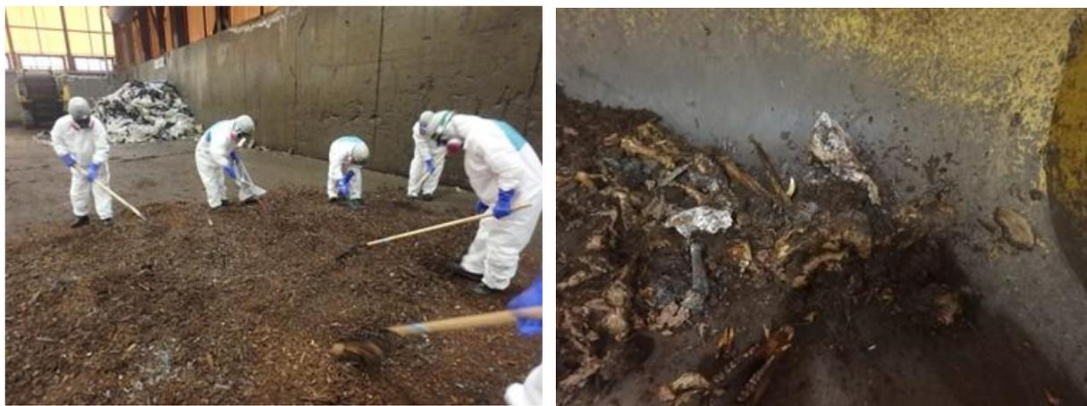
図 4- 26 人力による軟化処理残さ選別及び選別後の軟化処理残さ
