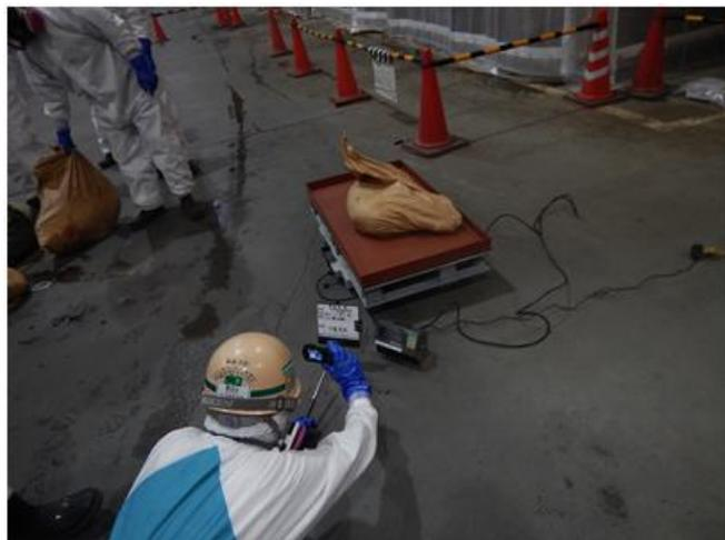
図 4- 15 フロアスケールでの計量
