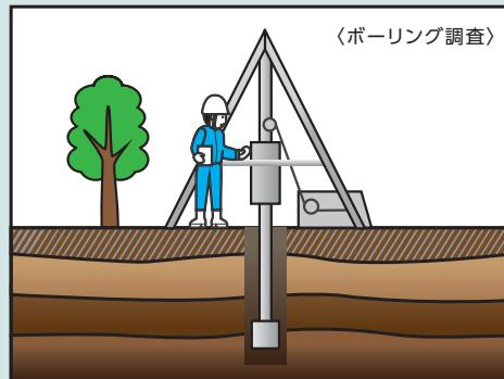
ボーリング調査を行い、地中の試料（地盤）を採取することで、候補地の地質・地盤性状を把握します。また、併せて地盤の固さや締まり具合、透水性等を調査します。
