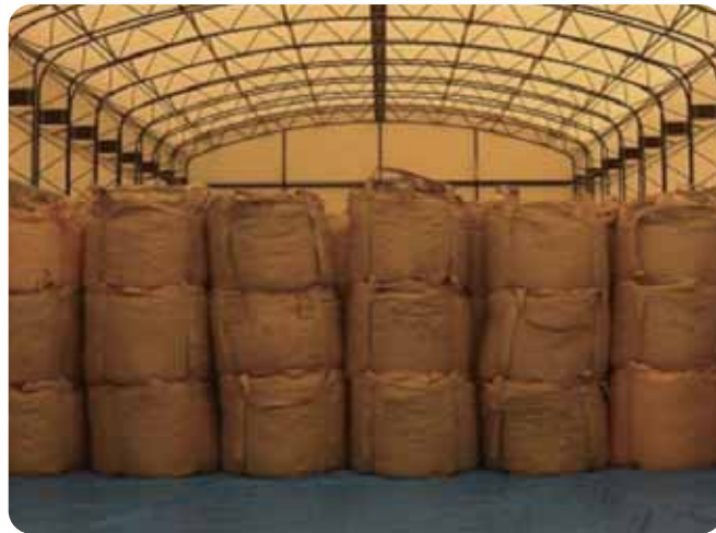
ごみ焼却施設では焼却灰を丈夫な袋に詰めて、テントなどの建屋内で一時保管しています。
