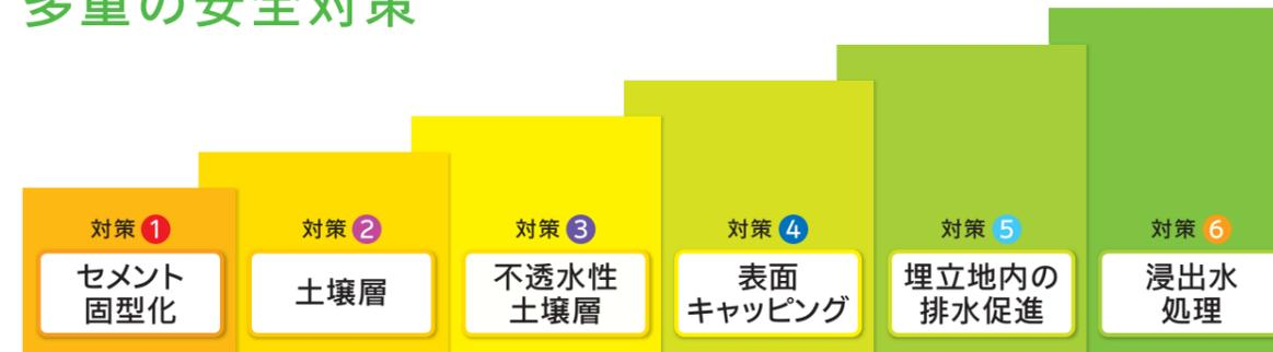
放射性セシウムが埋立地外へ漏出しないよう、多重の安全対策を実施します。
