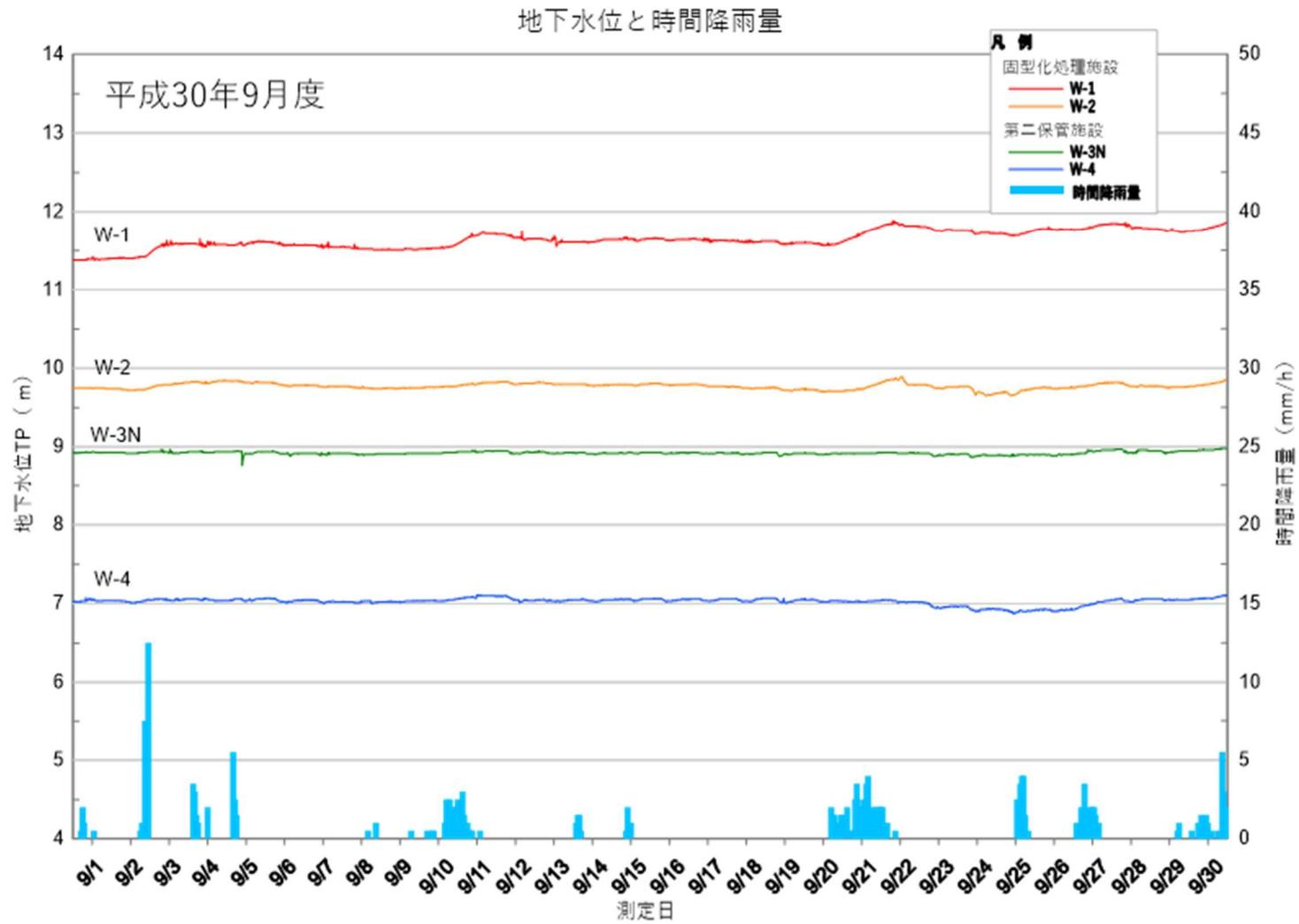
図-3 地下水水位測定結果及び時間降雨量（平成30年9月度）
