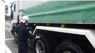
⑨車両の表面汚染密度の計測
