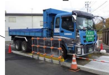
⑨車両の表面汚染密度の計測
