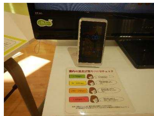
↑ 設置した二酸化炭素濃度計と 二酸化炭素濃度の判断目安
