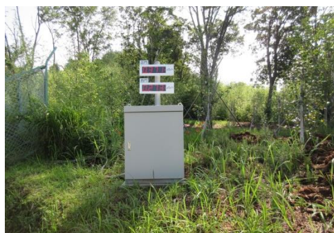
線量率表示機 (正門付近に設置)
