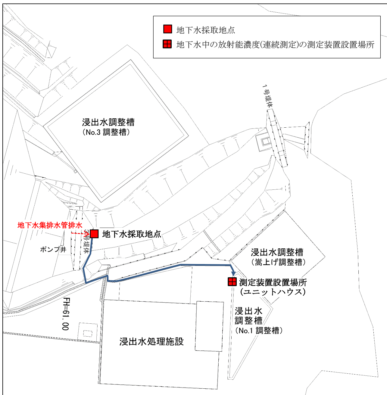
図 3-1-1 地下水中の放射能濃度(連続測定)の調査地点
