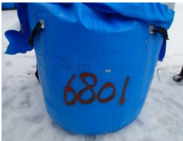
図3-11 飛灰の輸送時の荷姿（例） （寸法：直径 1m 程度）
