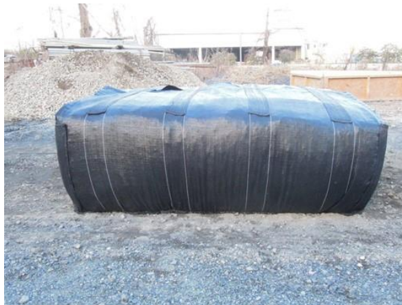
図3-9 主灰、不燃物等の輸送時の荷姿 (例) (寸法：縦 1500mm×横 1500mm×高さ 500mm)
