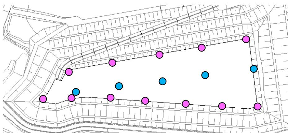
図 2-19(2) ガス抜き管平面配置（2期埋立地）
