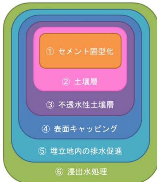
図 1-10 放射性物質の漏出に対する多重防護の概念図
