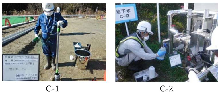
写真 4.4 地下水試料の調査状況
