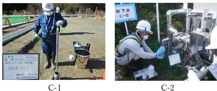
写真 4.5 地下水の調査状況
