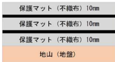
図 1-6(2) 処分場底部の遮水工の拡大図 (1期埋立地及び2期埋立地)
