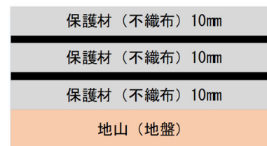
図 1-6(2) 処分場底部の遮水工の拡大図(1期埋立地及び2期埋立地)
