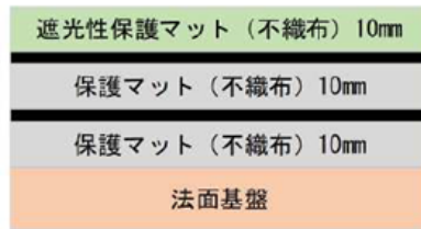
図 1-6(2) 処分場底部の遮水工の拡大図 (1期埋立地及び2期埋立地)
