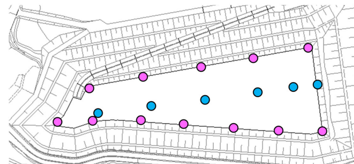
図 2-19(2) 集排水管平面配置 (2期埋立地)
