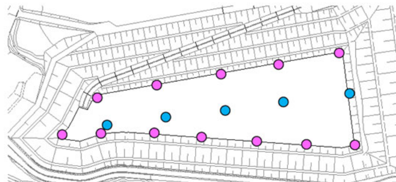
図 2-19(2) ガス抜き管平面配置 (2期埋立地)
