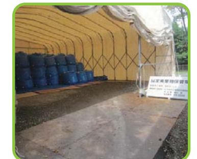
指定廃棄物(焼却灰)の保管状況
