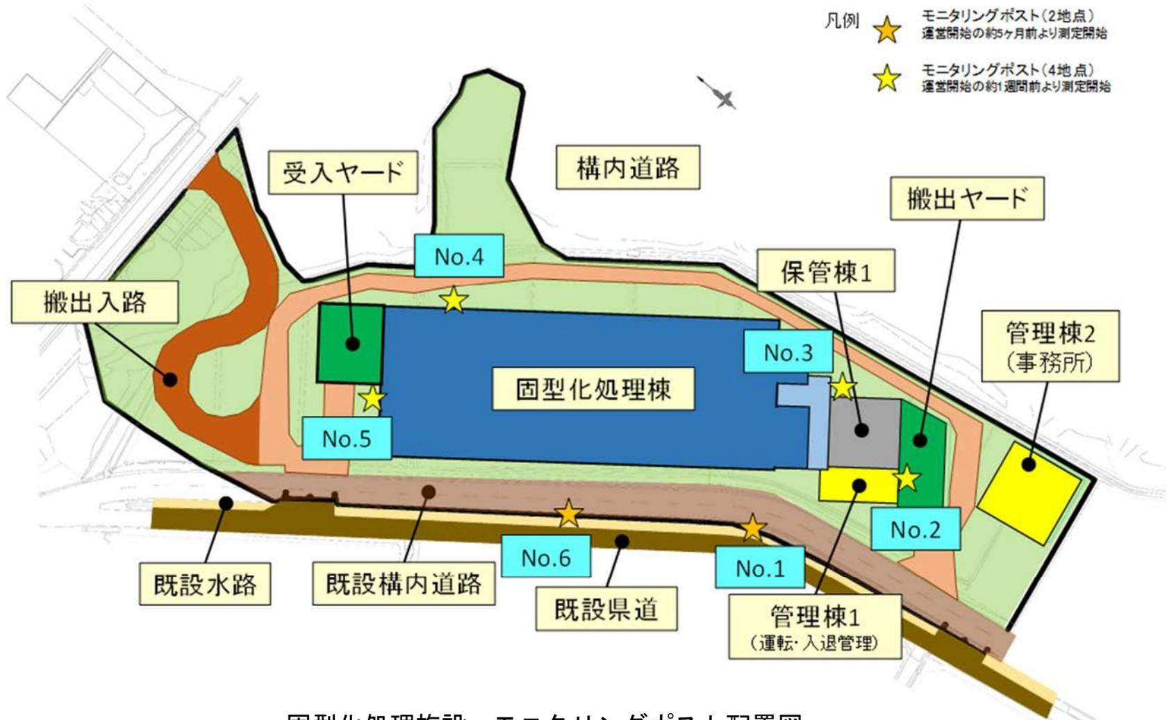
固型化处理施設 モニタリングポスト配置図
