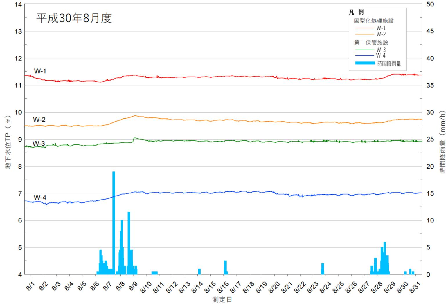
図-3 地下水位測定結果及び時間降雨量（平成30年8月度）
