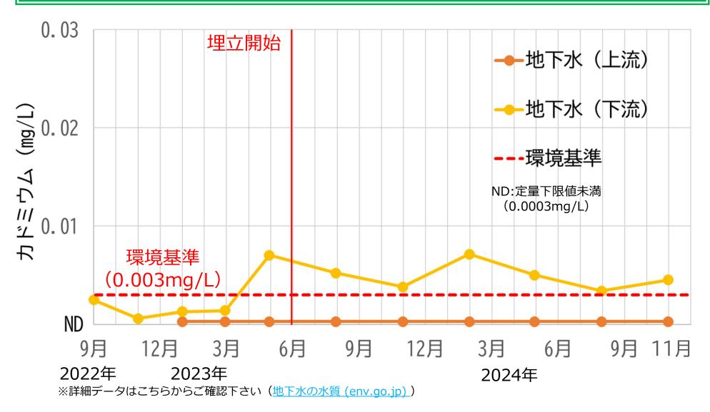
地下水下流(C-2)では埋立開始前の5月より継続して地下水環境基準を超過する値が確認されてきましたが、11月は基準を下回る0.78mg/Lでした。 これらは自然由来である可能性が高く、有識者の御意見を伺いつつ引き続き動向を注視して参ります。
