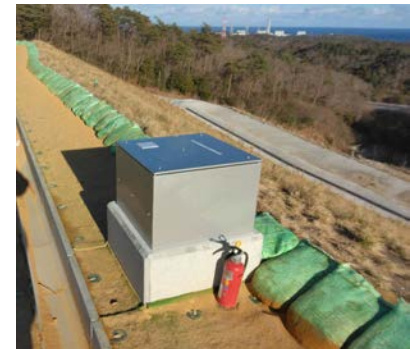
下流側区画の11段目土堰堤天端に設置した地震計（11月5日設置）
