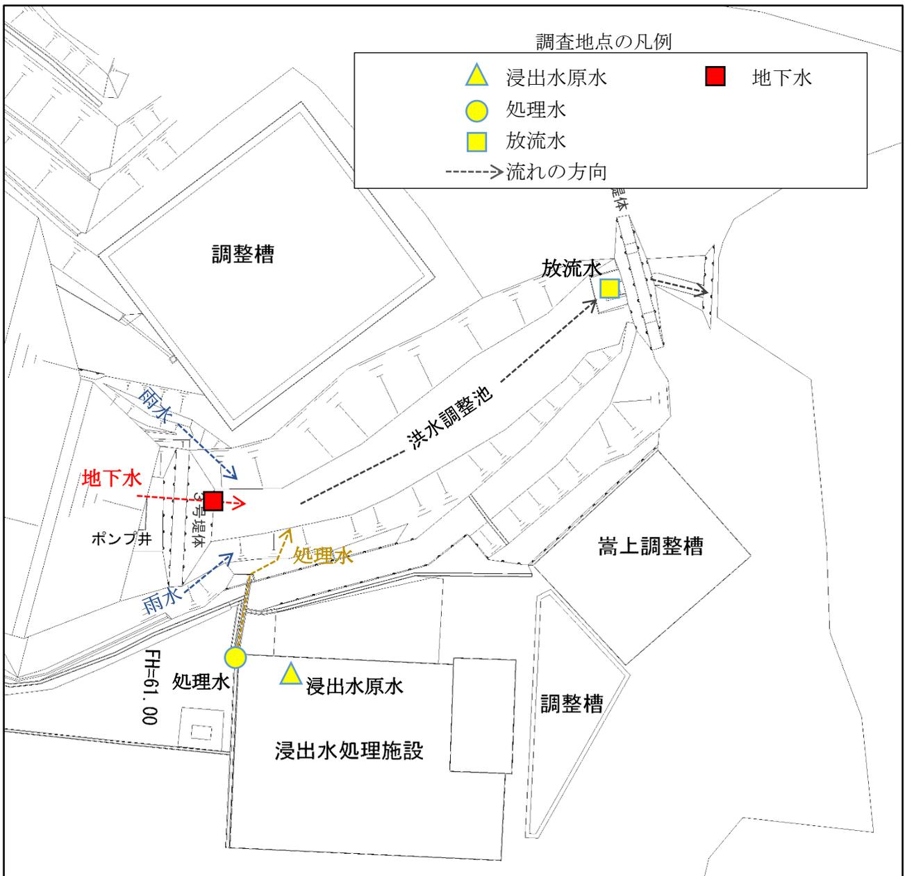
浸出水原水、処理水、放流水及び地下水の調査地点
