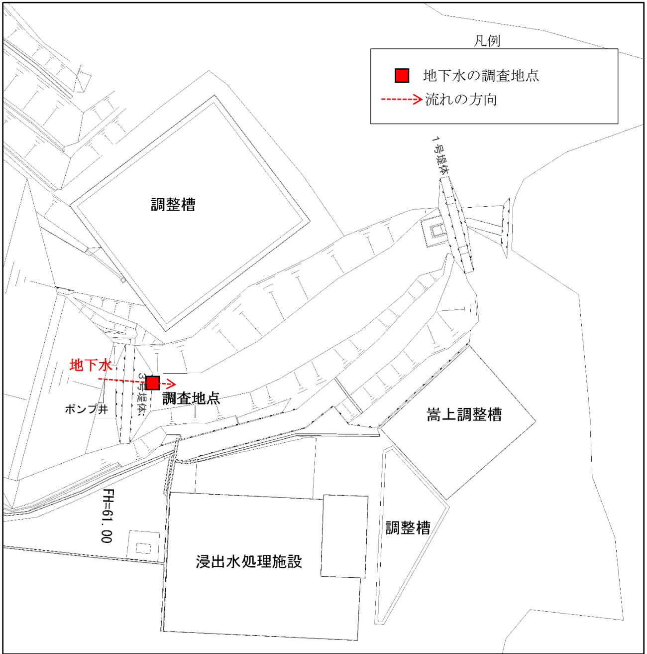
地下水の調査地点
