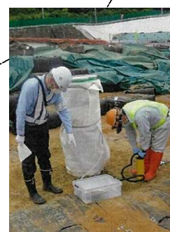
縦管における 埋立ガス採取の状況 (令和2年6月場内下流)
