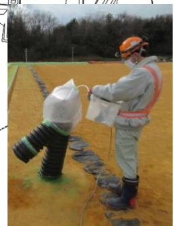
豎管における 埋立ガス採取の状況 (令和7年1月下流(南側))
